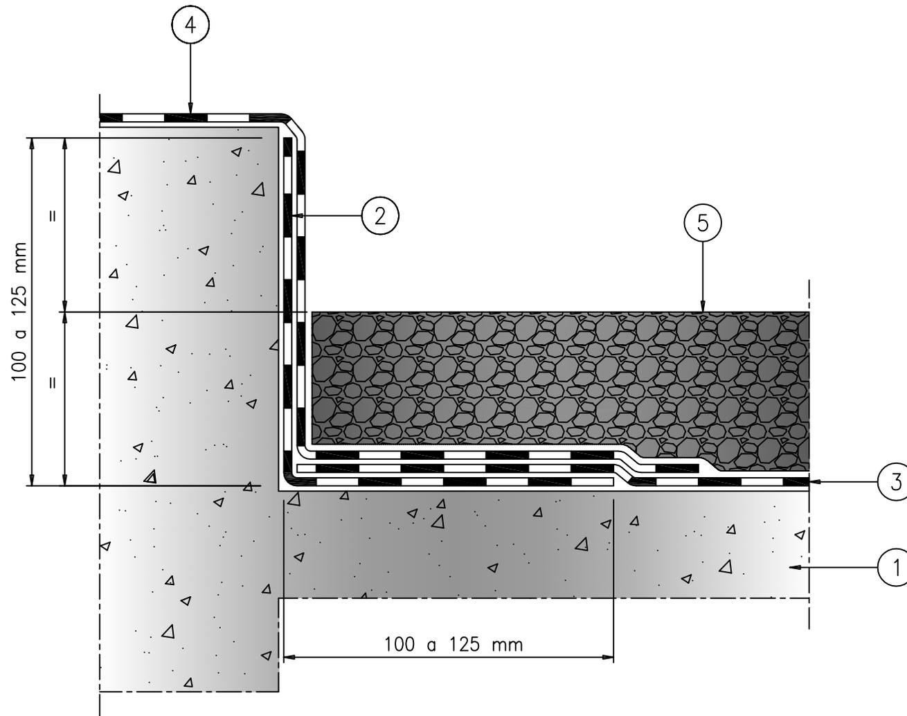
1. Supporto trattato con primer bituminoso "PRIMERTEC AD" o resina epossidica
